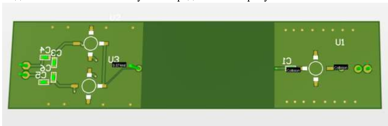
Рисунок 3.8 – 3D представление печатной платы, вид сзади
