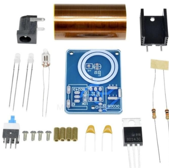
Рис. 7. Набор деталей «Катушки Тесла»
