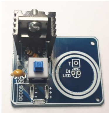
Рис. 13. Установка керамического конденсатора
