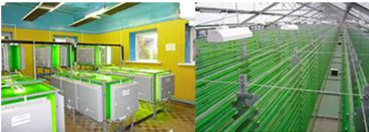
Рисунок 2.4 – Биореакторы открытого глубинного типа и закрытые установки интенсивного типа – трубчатые (слева направо) [6]
