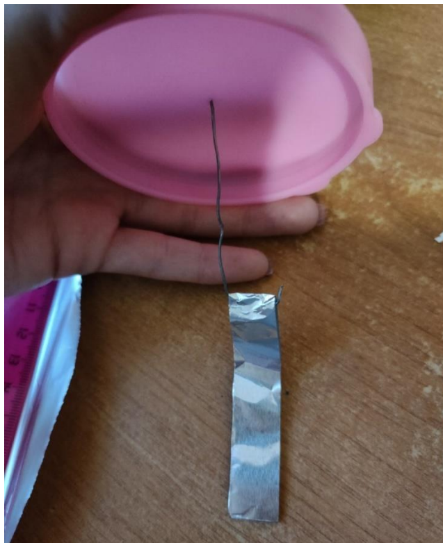
Рис. 18. Крючок из проволоки с листом фольги, продетый через отверстие в крышке
