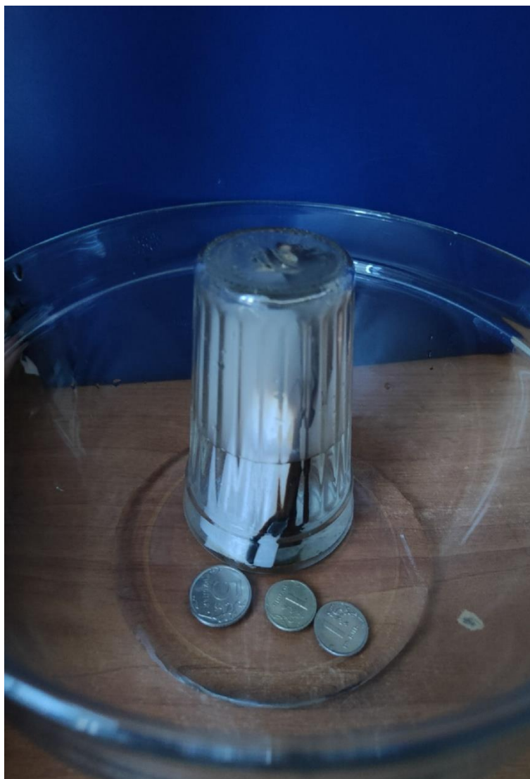
Рис. 7. Вода под действием атмосферного давления входит в стакан
