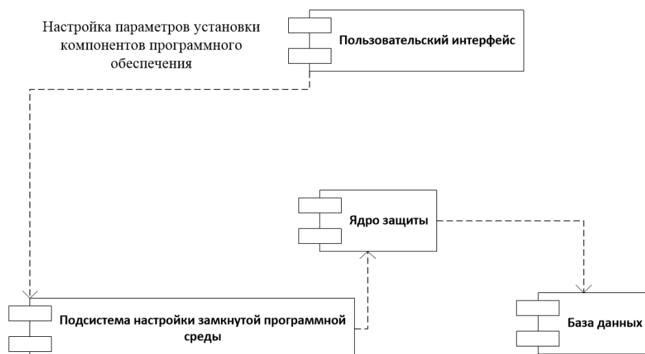
Рисунок 29 - Настройка параметров установки компонентов программного обеспечения
