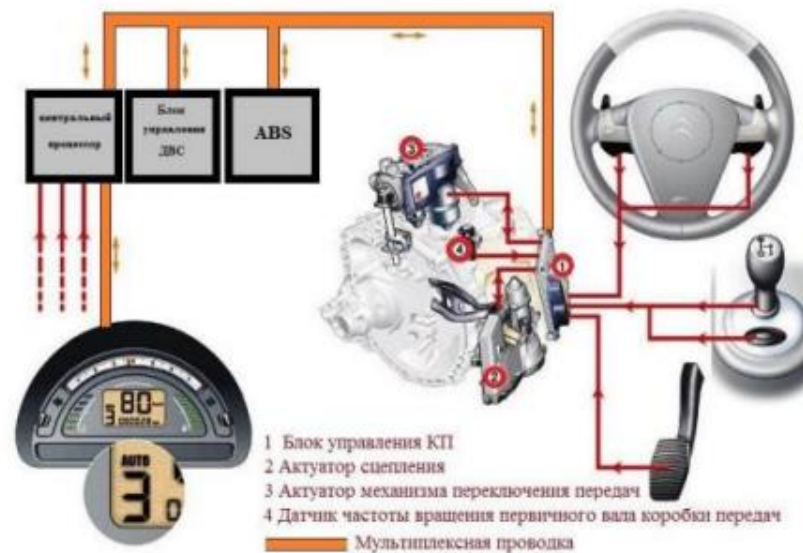
Пример использования сети CAN в бортовой системе автомобиля
