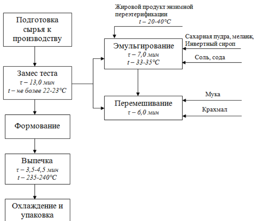
Рисунок 2.15 - Технологический процесс изготовления печенья
