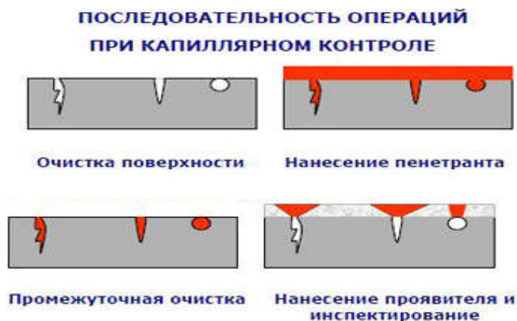
Рисунок 22 – Контроль сварных соединений капиллярным методом
