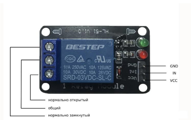
Рисунок 6 – Схема подключения реле
