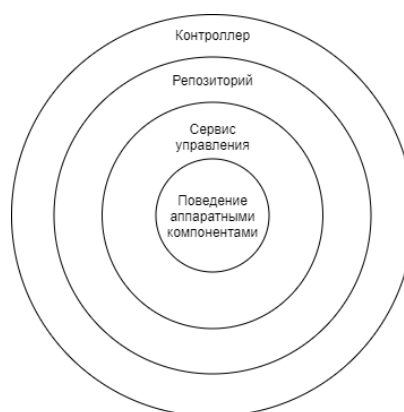
Рисунок 23 – Архитектура приложения контроллера
