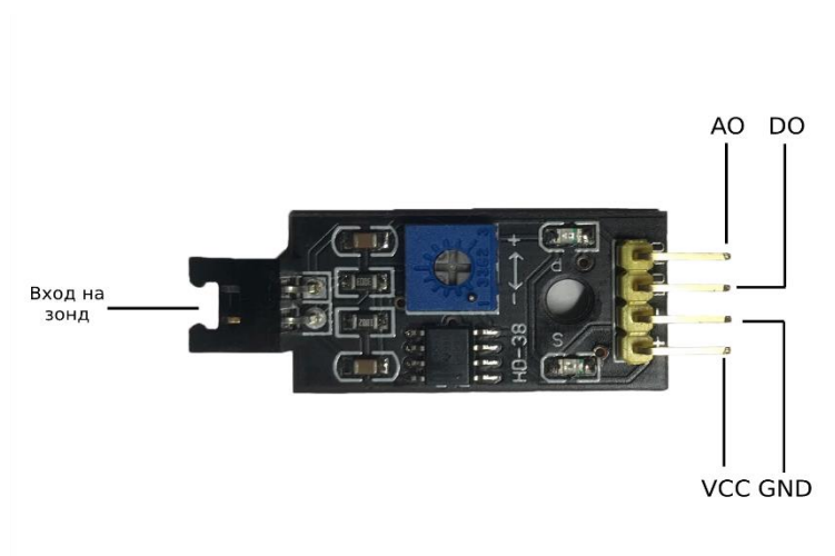
Рисунок 4 – Схема подключения ДВП
