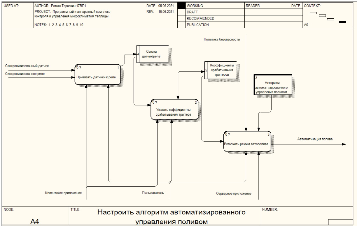
Рисунок 14 – Диаграмма декомпозиции «Настроить алгоритм автоматизированного управления поливом» в нотации DFD
