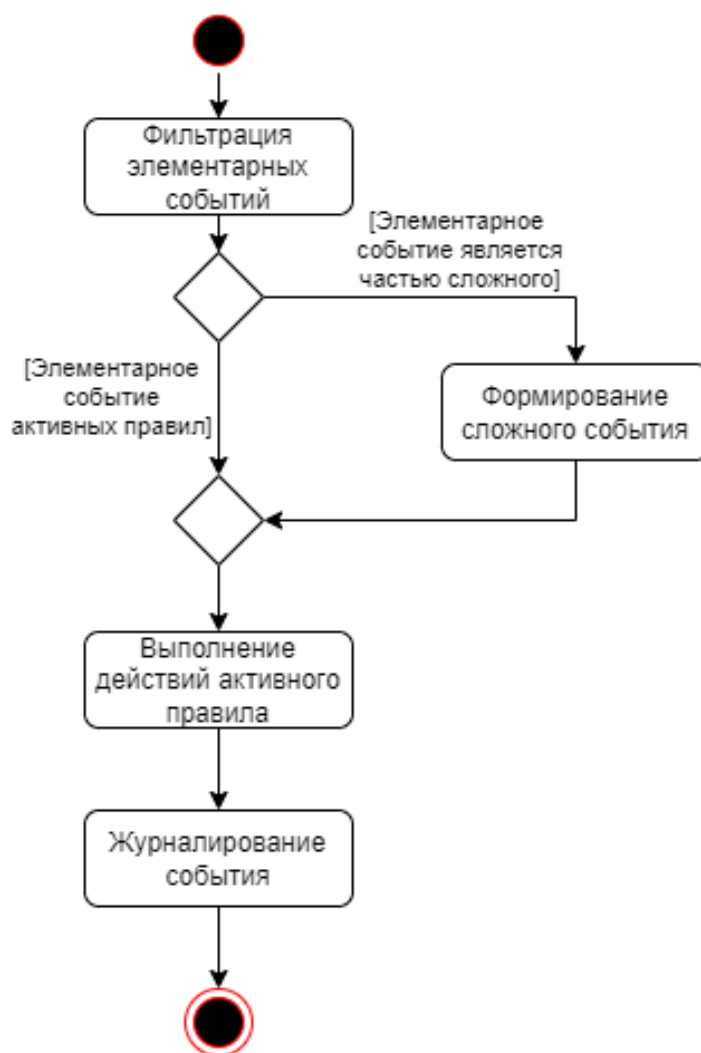
Рисунок 8 – Функционирование системы потоковой обработки событий с применением активных правил
