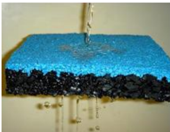
Рисунок 2.6 - Пример того как резиновое покрытие пропускает воду.
