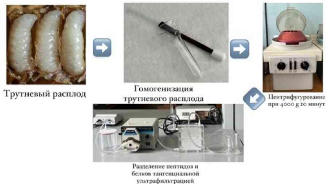
Рисунок 2. Общая схема выделения, очистки и разделения пептидных фракций с молекулярной массой 5-10 кДа
