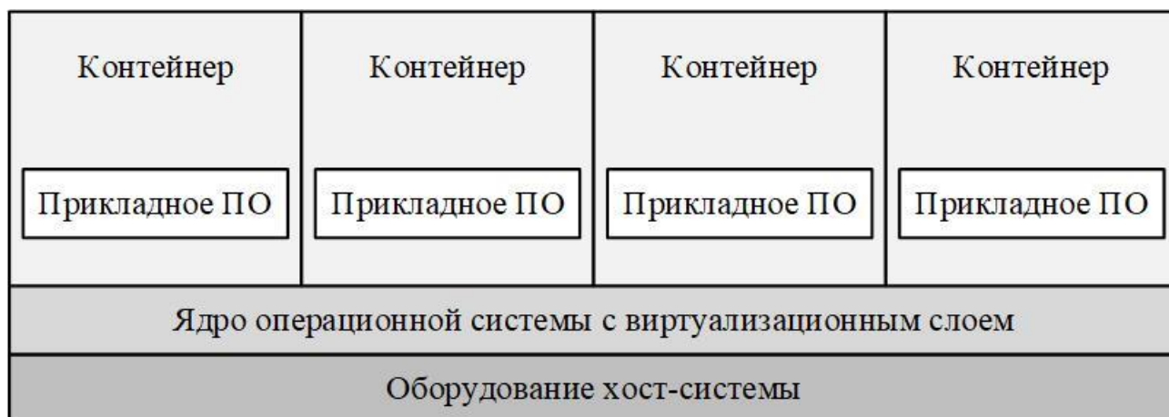
Рисунок 3 – Схема работы контейнерной виртуализации
