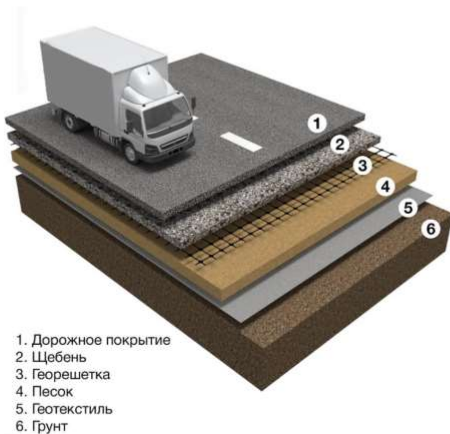
Рисунок 2.3 – Строительство автомобильной дороги
