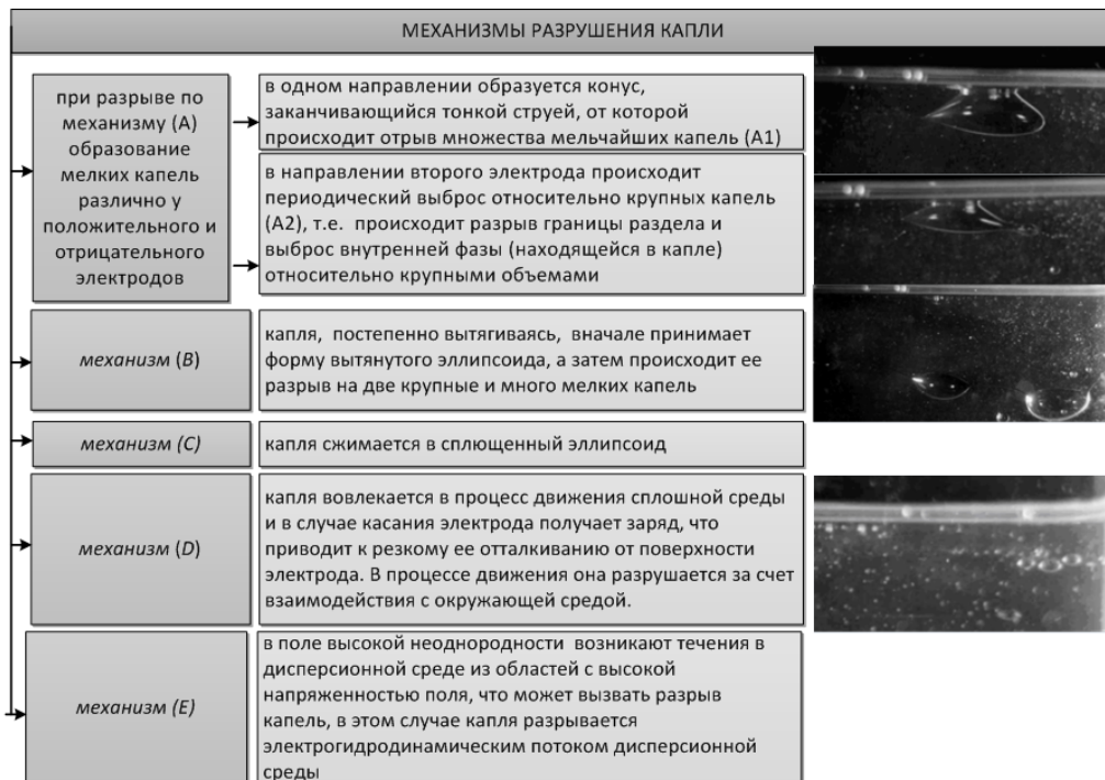
Рисунок 4 – Новая классификация механизмов разрушения капель эмульсии в электрическом поле
