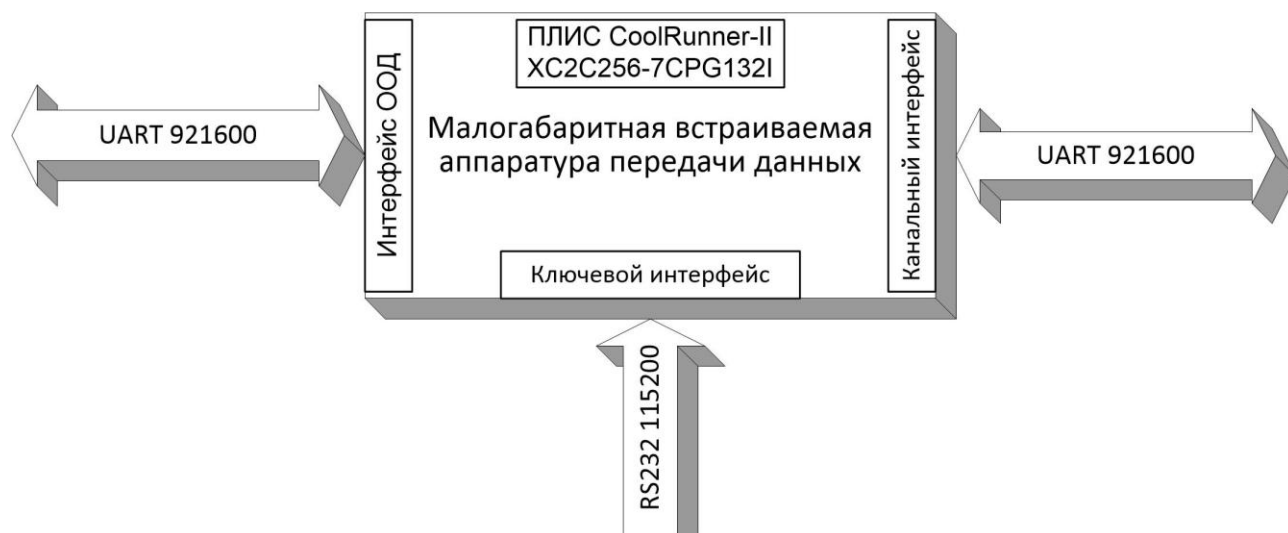
Рисунок 12 – Обобщенная структурная схема малогабаритной встраиваемой аппаратуры передачи данных
