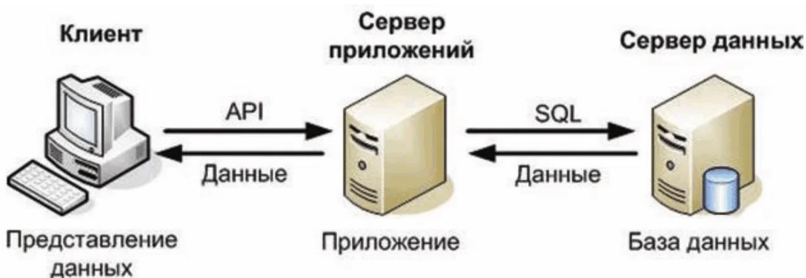
Рисунок 30 – Трехуровневая архитектура «Клиент-сервер»
