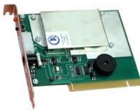
Рисунок 5 – Генератор шума ГШ-К-1800
