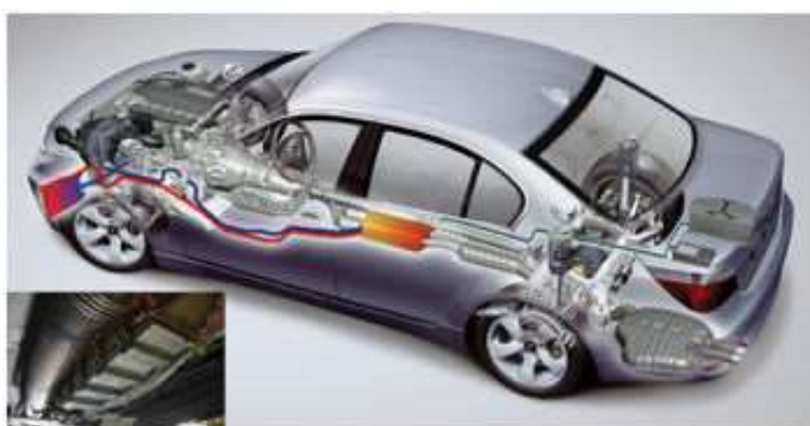
Рисунок 1.4 – Термоэлектрические генератор под днищем BMW
