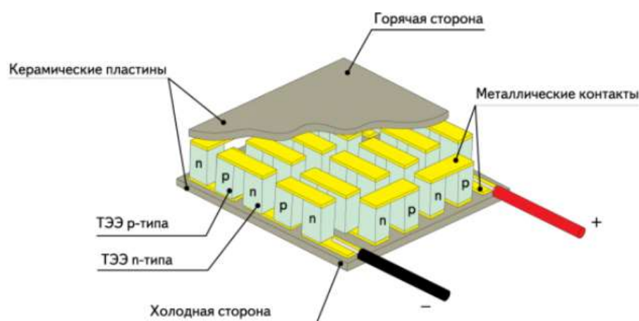
Рисунок 1.1 – Конструкция термоэлектрического модуля
