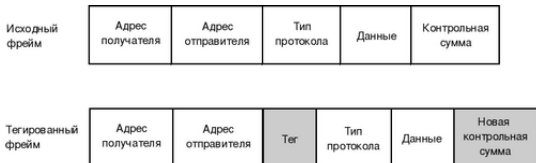
Рисунок 16 — Формат кадра Ethernet с добавлением тега
