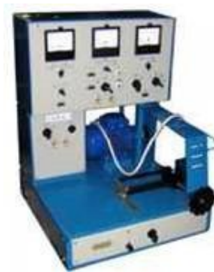
Рисунок 2.10 - Диагностический стенд для проверки электрооборудования
