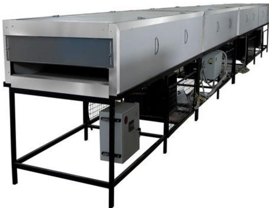
Рисунок 8 – Охлаждающий тоннель и накопитель
