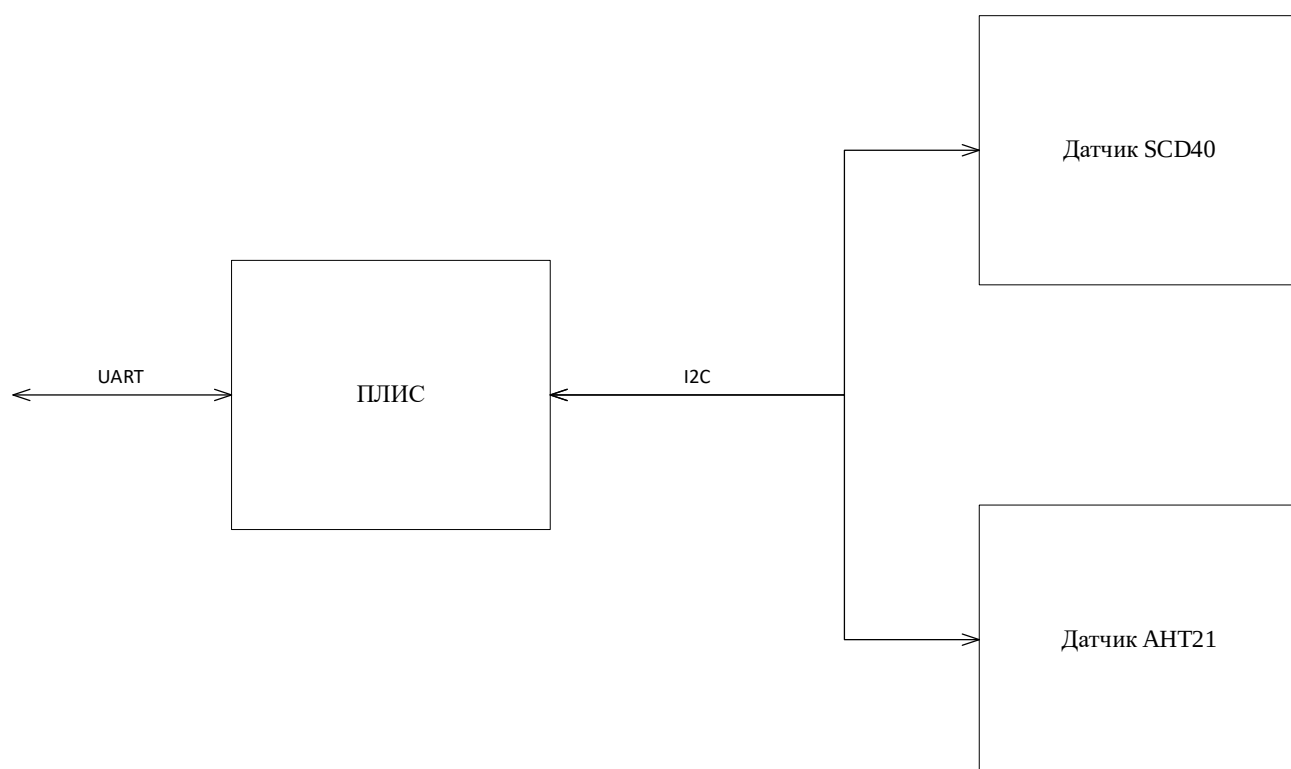
Рисунок 20 – Структурная схема аппаратной части комплекса
