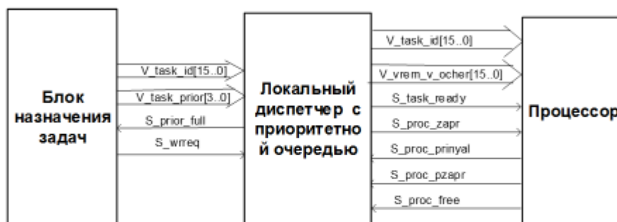
Интерфейс взаимодействия процессора с диспетчером в планировщике с локальными очередями задач
