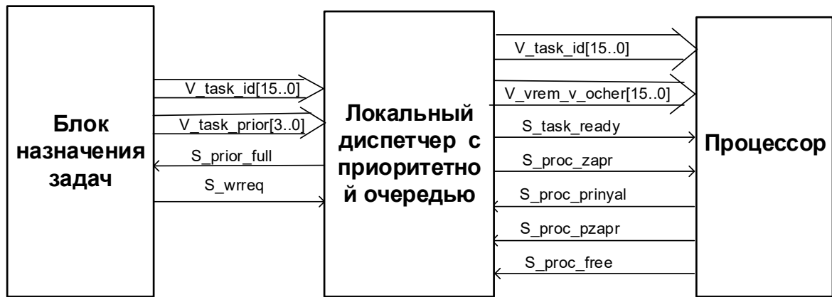
Рисунок 33 - интерфейс взаимодействия устройства локального диспетчера с каждым из процессоров и с планировщиком задач
