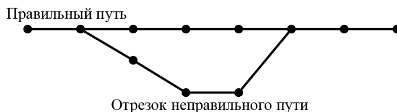
Рисунок 7 – Случай выбора декодером Витерби неправильного пути
