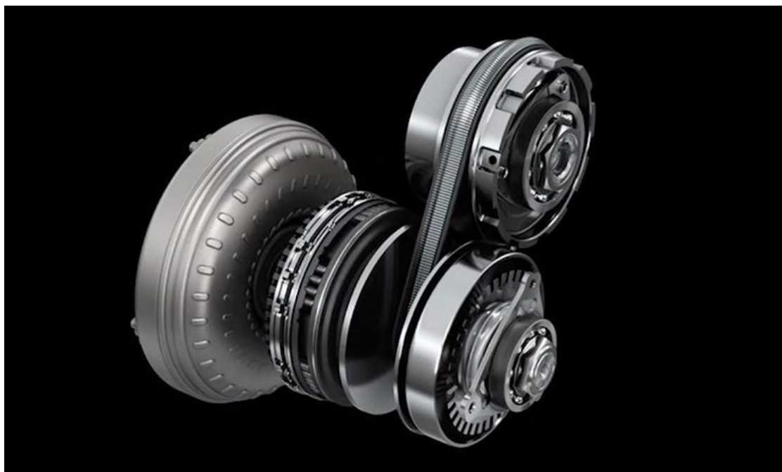
Рисунок 1.4 – Клиноременный вариатор Nissan
