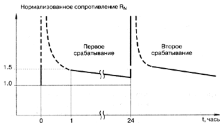
Рисунок 11 – Сопротивление предохранителя в ходе первых срабатываний
