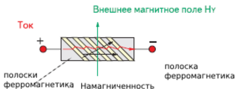
Рисунок 4 - Технология с включением шунтирующих полос в слой ферромагнетика
