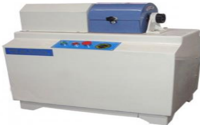
Рисунок 2.10 – Станок для изготовления черенков
