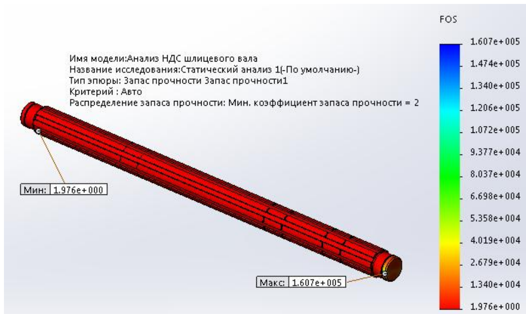
Рисунок 17 – Эпюра запаса прочности шлицевого вала
