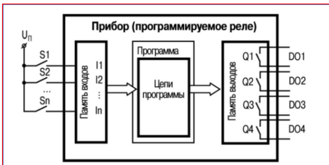
Рисунок 2 – Функциональная схема выполнения программы ПЛК
