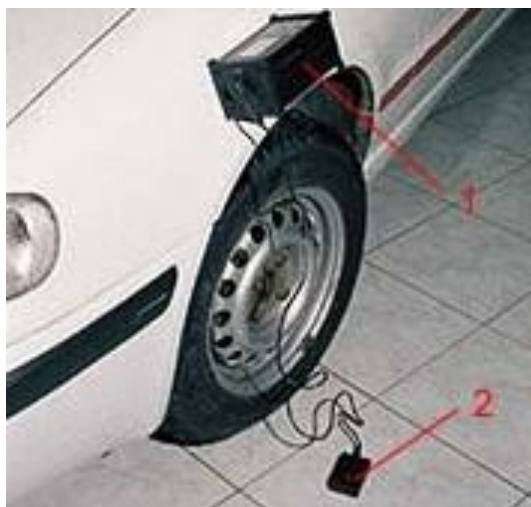
Рисунок 4.2 – Амплитудный метод диагностики
