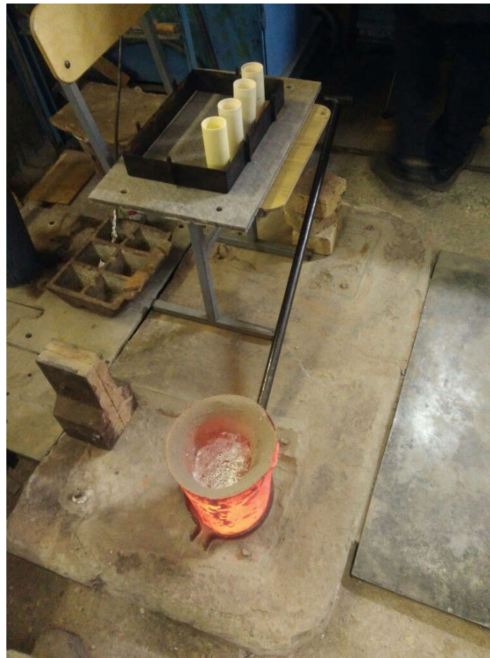
Рисунок 4 – Заливка металла в тигли с расплавленными флюсами
