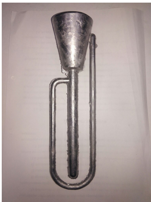
Рисунок 4.6 – Образец на жидкотекучесть залитый в U -пробу из сплава рафинированного расплавленными флюсами
