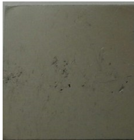
Рисунок 4.4 – Пористость после рафинирования расплавленными флюсами
