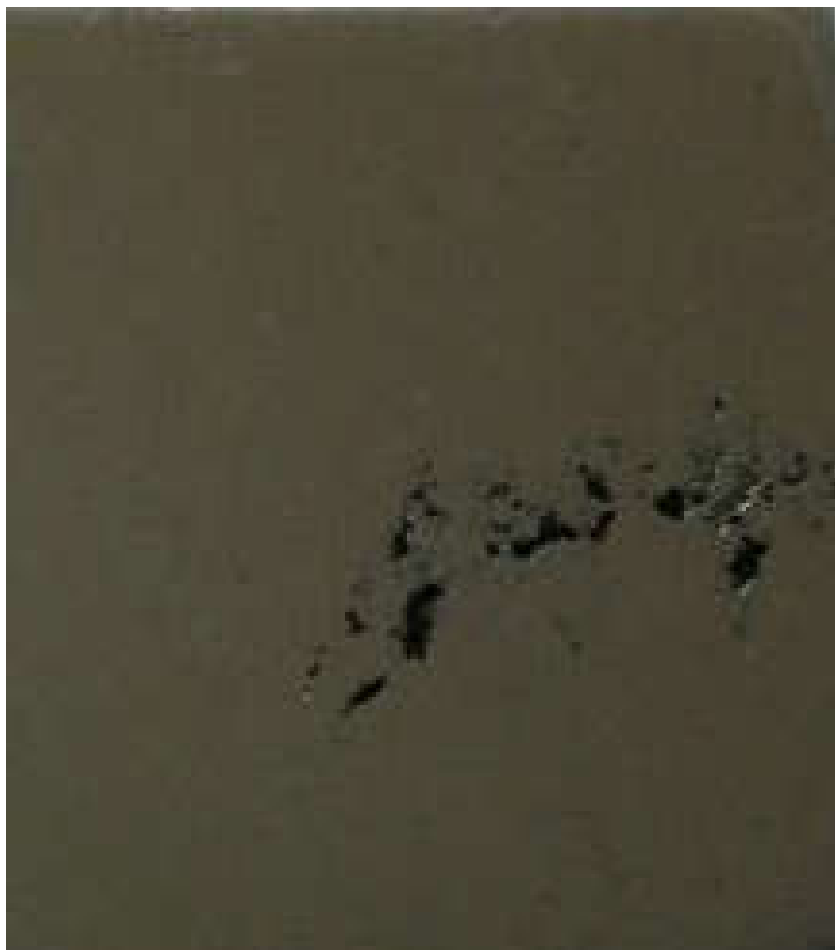
Рисунок 7 – Пористость после рафинирования покрывными флюсами
