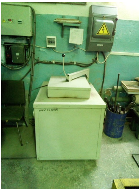
Рисунок 3.1 – Печь марки СШОЛ 60/12-Т в закрытом состоянии
