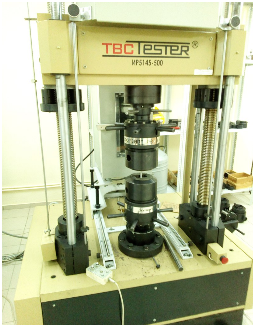
Рисунок 4.10 – Разрывная машина IP5145-500
