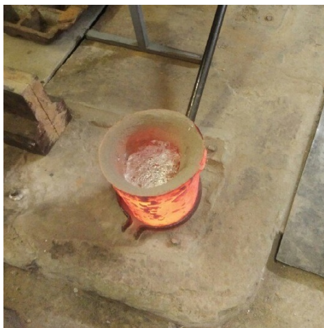
Рисунок 3.2 – Тигель с расплавленным силумином АК-7 до рафинирования
