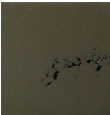
Рисунок 4.3 – Пористость после рафинирования покрывными флюсами
