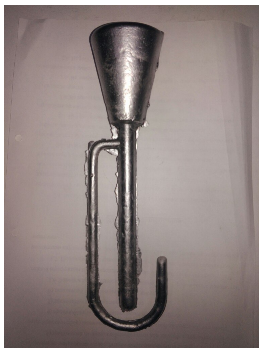
Рисунок 4.7 – Образец на жидкотекучесть залитый в U -пробу из сплава рафинированного покрывными флюсами
