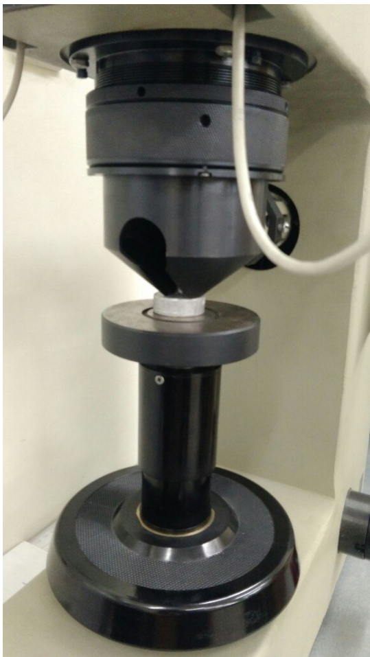
Рисунок 4.14 – Проведение испытания образца из АК-5М2 на твердомере
