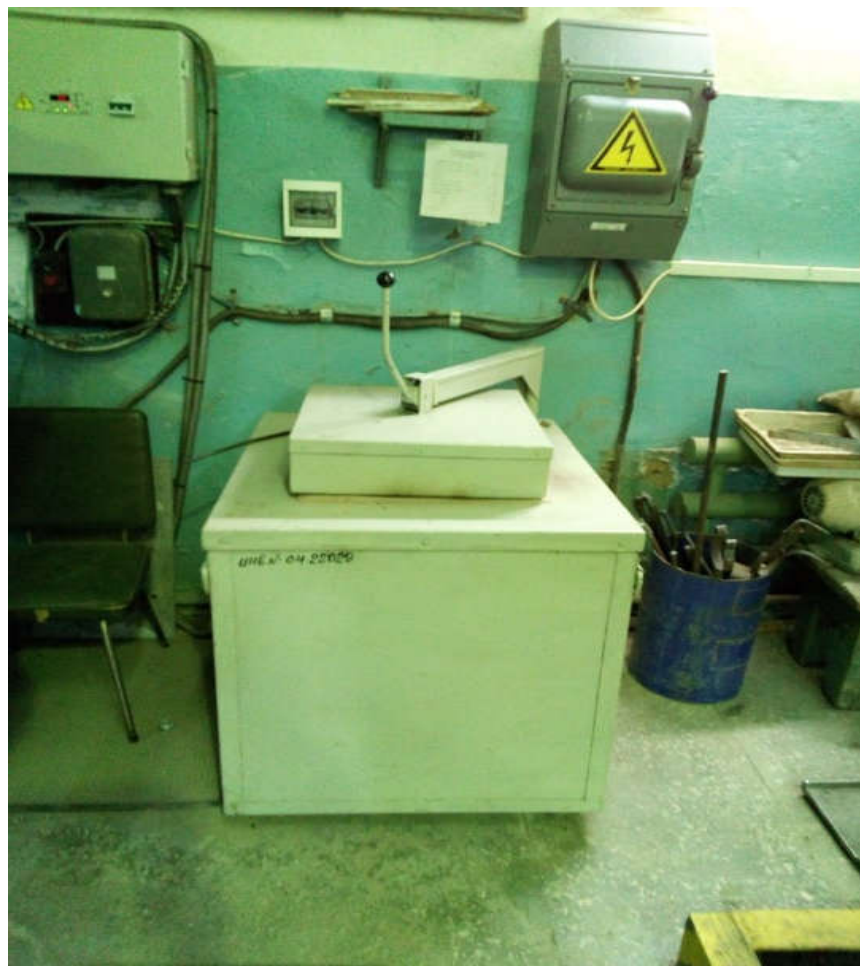
Рисунок 1 – Печь марки СШОЛ 60/12-Т в закрытом состоянии
