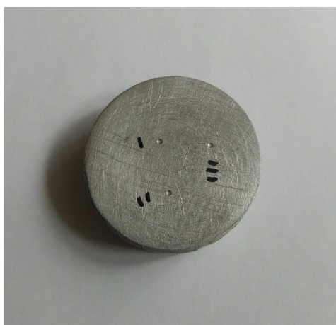
Рисунок 4.13 – Образец для определения твердости по Бринеллю
