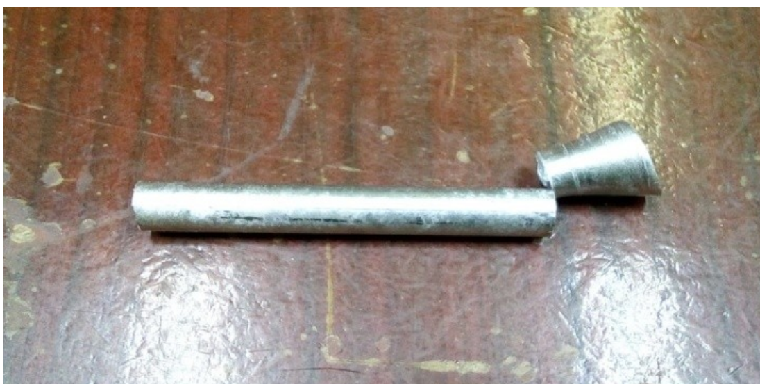
Рисунок 3.5 – Отливка для изготовления образца на растяжение
