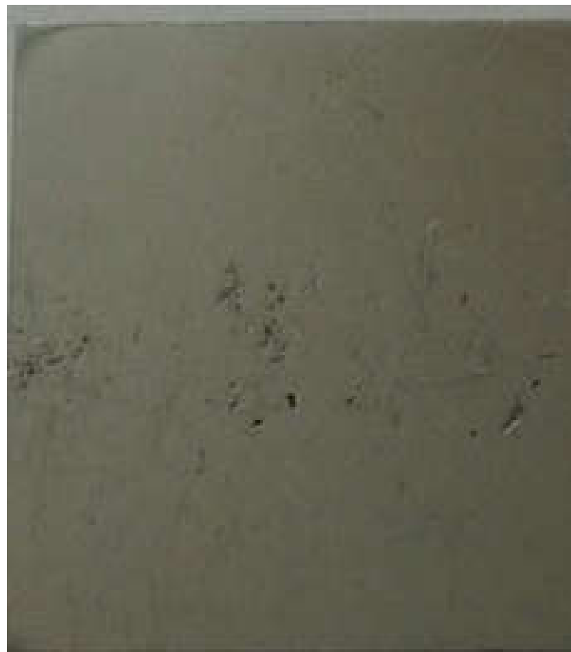
Рисунок 8 –Пористость после рафинирования расплавленными флюсами
