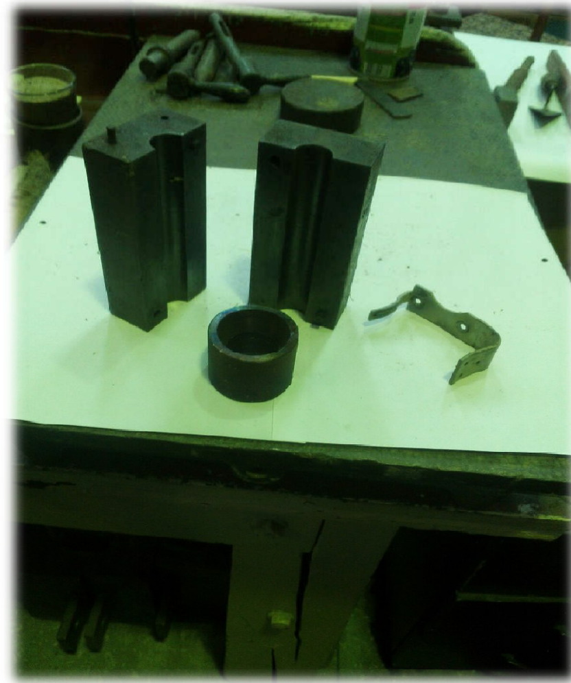
Рисунок 2 – Две полуформы кокиля
