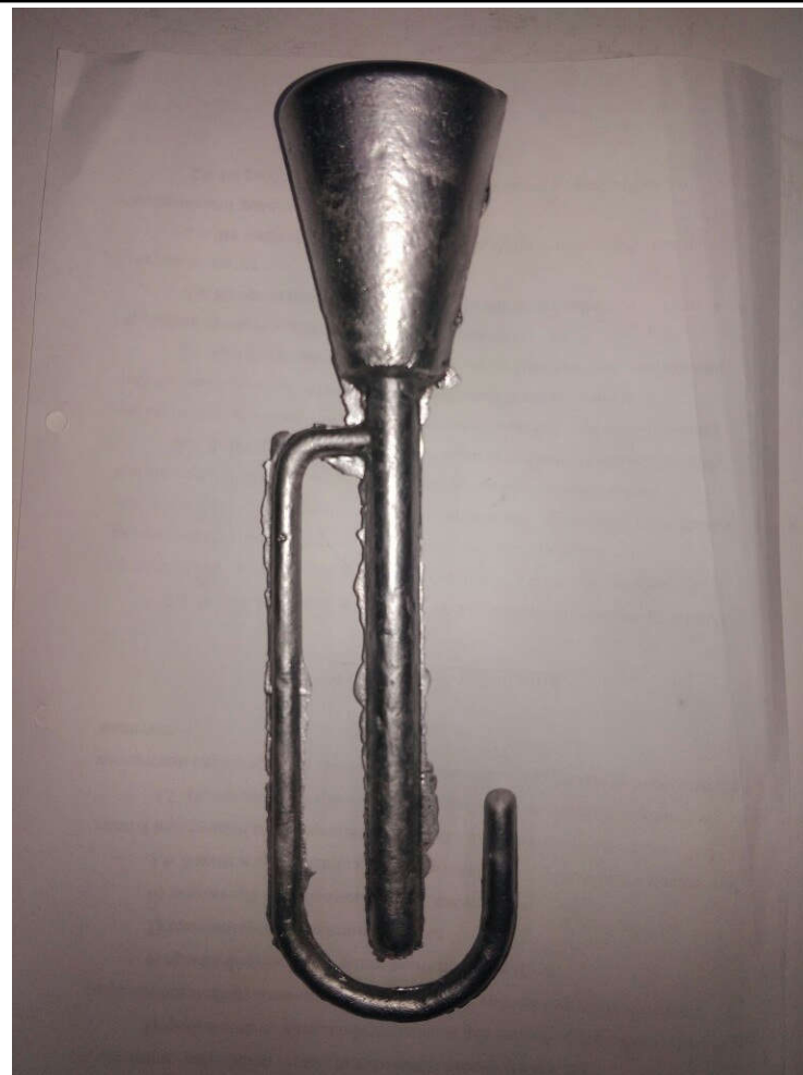
Рисунок 6 – Образец на жидкотекучесть, залитый в U пробу, из сплава рафинированного покрывными флюсами
