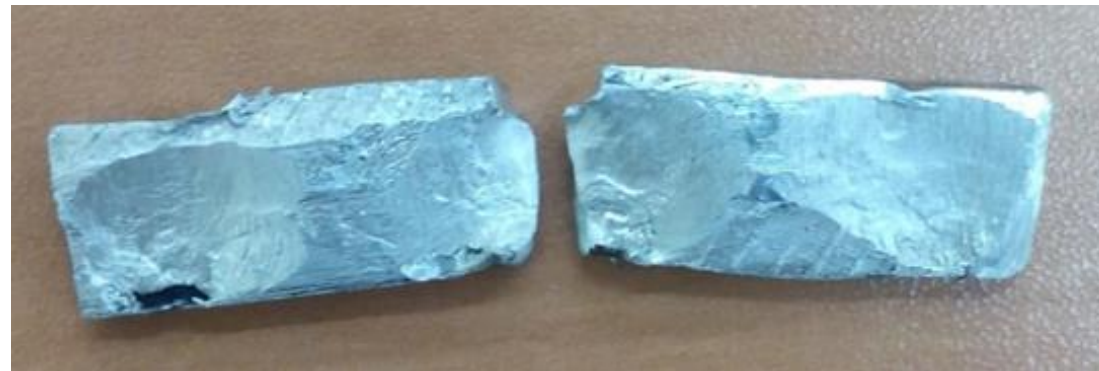
Рисунок 7 – Общий вид образцов для испытания на ударный изгиб: а) – размеры образцов, мм; б) – вид образца №1 до испытания; в) – вид образца №3 после испытания
