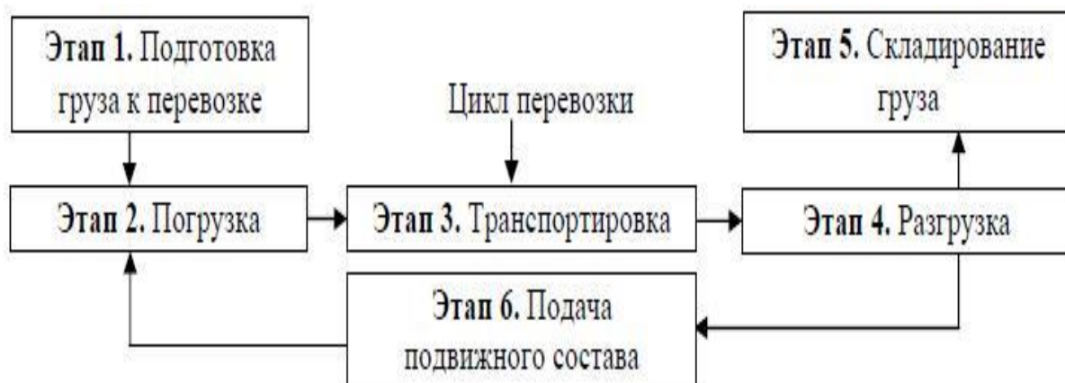
Рисунок 1.1 – Технологическая схема процесса перевозки грузов одним видом транспорта
