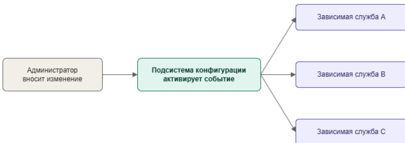
Рисунок 11 – Схема оповещения об изменении настроек
