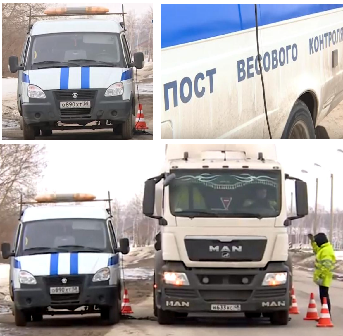
Рисунок 1.19 – Передвижной пост весового контроля
