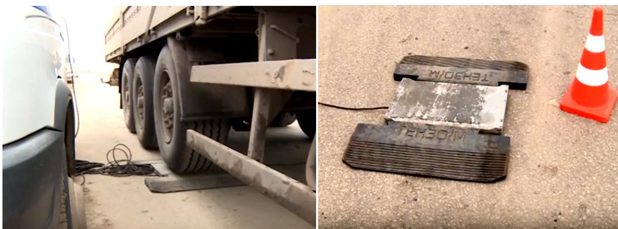
Рисунок 1.20 – Подкладные весы для измерения нагрузки на оси
