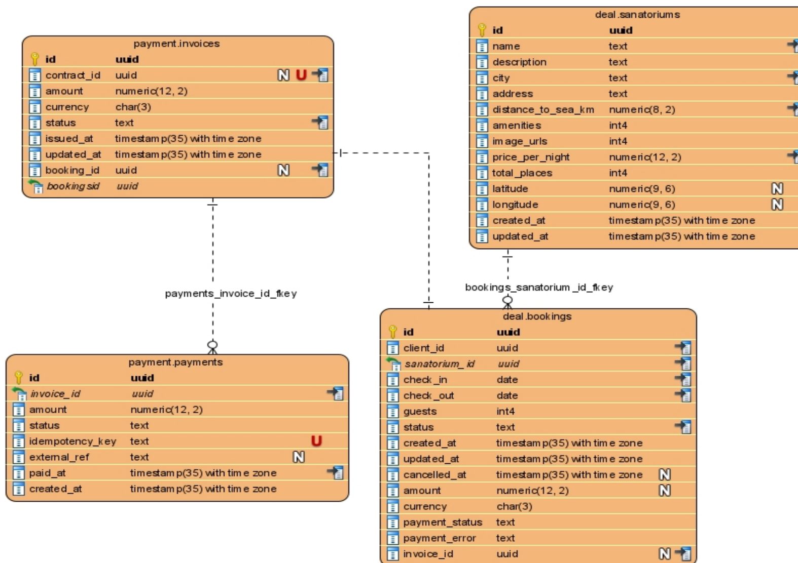
Рисунок 13 – Физическая модель данных (фрагмент)
