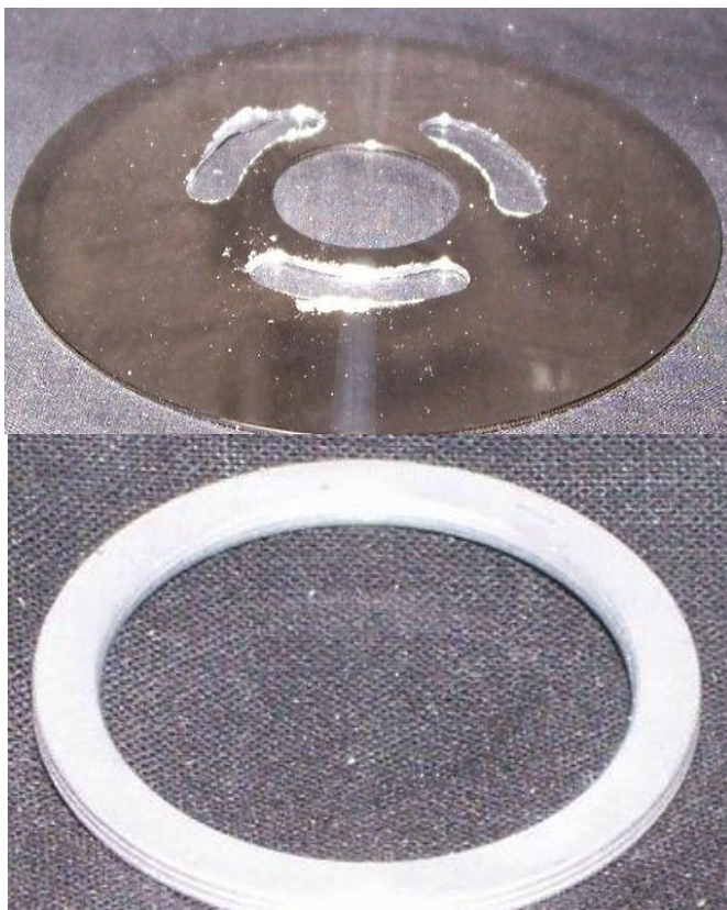
Рис. 8. Отверстия в жестком диске, готовые кольца
