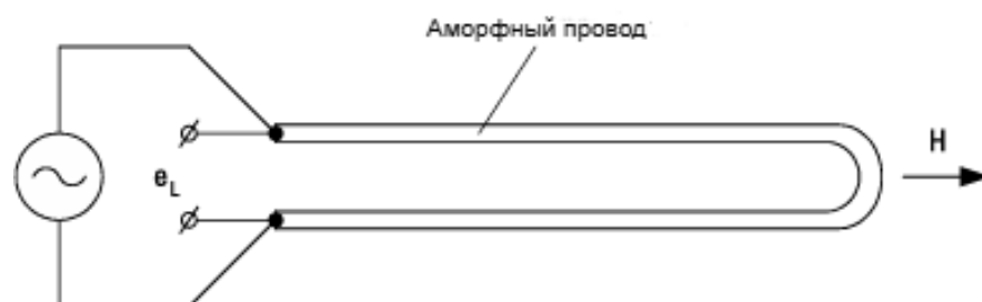
Рисунок 5 – Простая магнитоиндукционная головка с использованием аморфной проволоки
