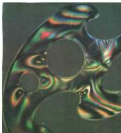
Рисунок 19. Внутреннее напряжение в детали.
