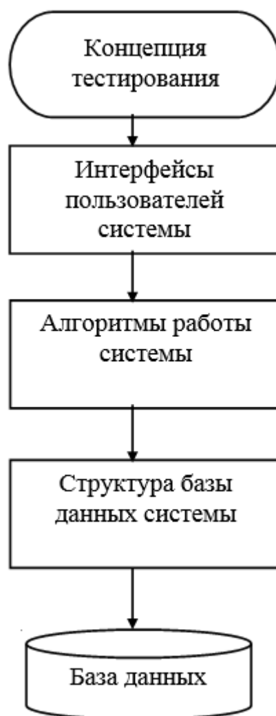
Рисунок 10 – Схема нисходящего проектирования системы тестирования
