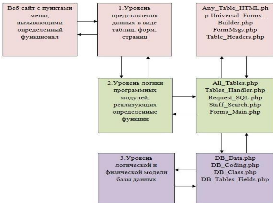
Рисунок 25 – UML – диаграмма классов структурная схема программного обеспечения
