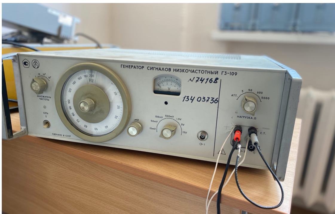
Рисунок 13 – Установленные органы управления генератора сигналов низкочастотный
