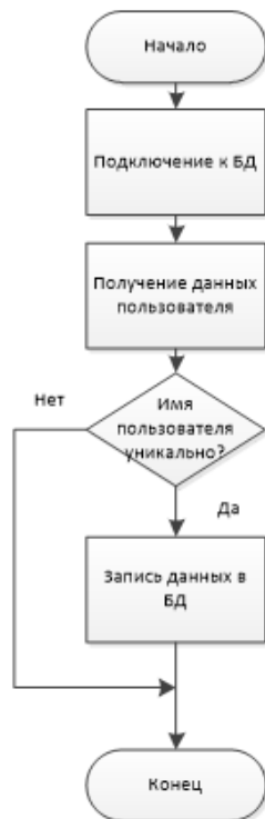
Рисунок 9 - Блок схема алгоритма регистрации пользователя
