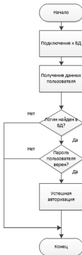
Рисунок 10 - Блок схема алгоритма авторизации пользователя
