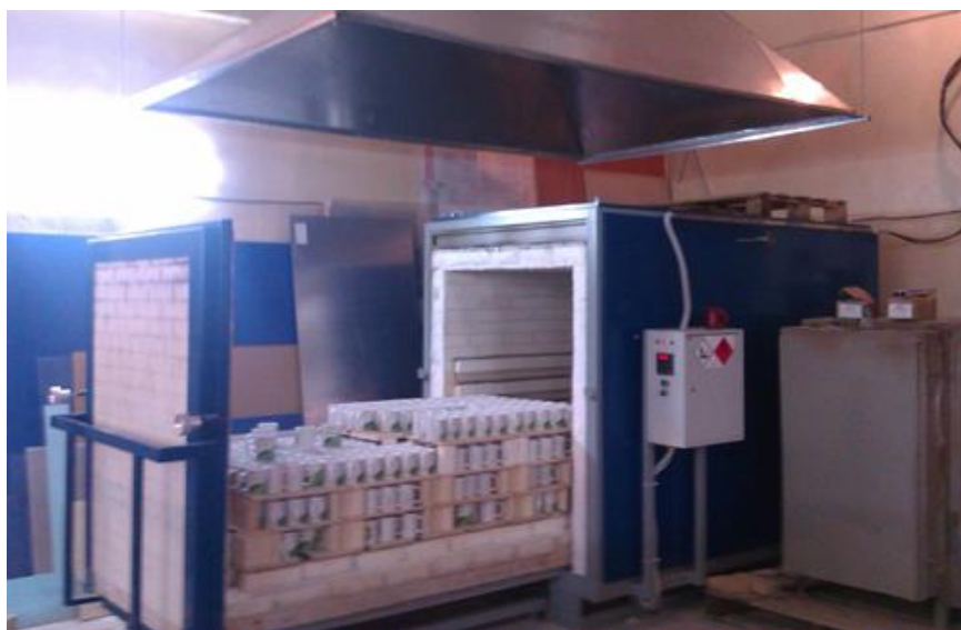
Рисунок 2.7 – Печь для обжига фаянсовой посуды [47]
