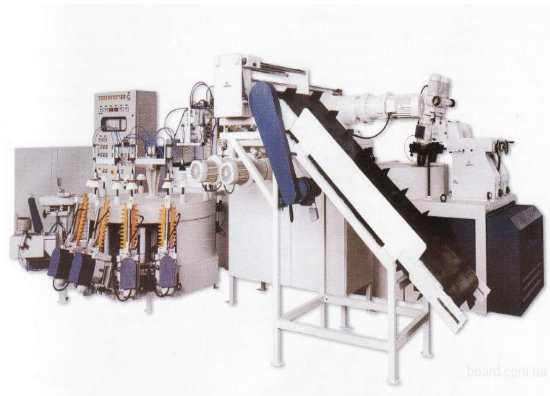
Рисунок 2.5 – Автоматическая линия для производства чашек [47]
