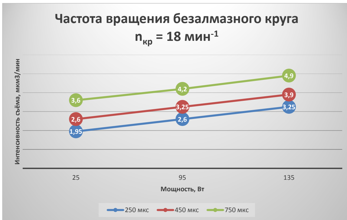
Рисунок 1.11 - Зависимость объёмной величины интенсивности съёма от величины мощности при частоте вращения безалмазного круга n_{кр} = 18 \text{ мин}^{-1}
