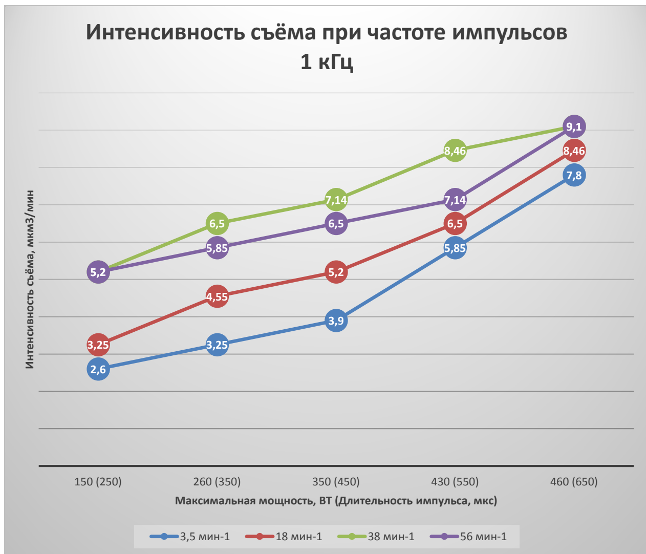
Рисунок 1.8— Зависимость объёмной величины интенсивности съёма от различных технологических режимов обработки
