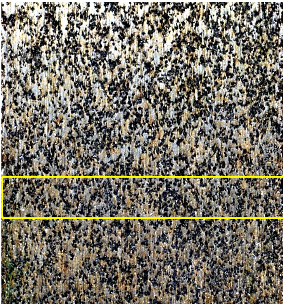
б) наружная поверхность круга (периферия) Размер зоны сканирования 10x10мм
