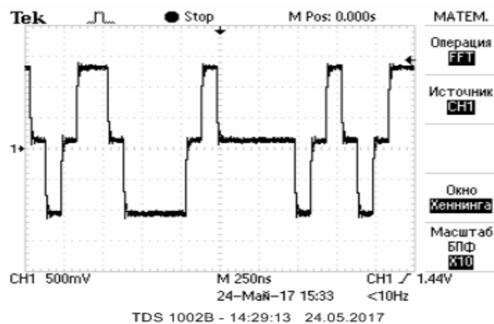
Рисунок 8.7 – Временная функция в формате кода MLT-3
