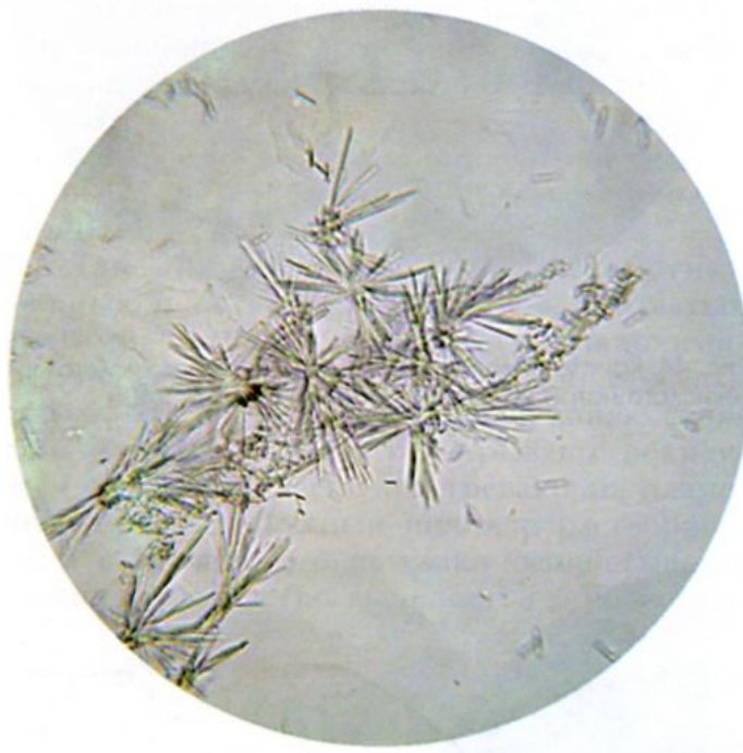
Рисунок 8. Кристаллы сернокислого стронция под микроскопом
