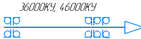
Рисунок 4.12 – Схемы установки подшипников шпиндельного узла
