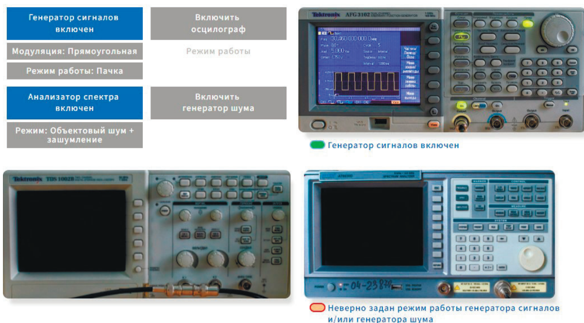
Рисунок 31 — Неверная настройка приборов
