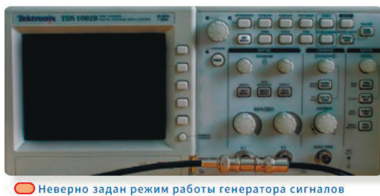
Рисунок 26 — Неверная настройка приборов
